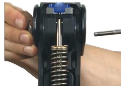
Schéma. 17 Suppression du mécanisme de frottement
