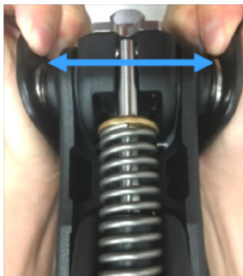
Schéma. 20 Retrait de la couverture ATK HydraPro
