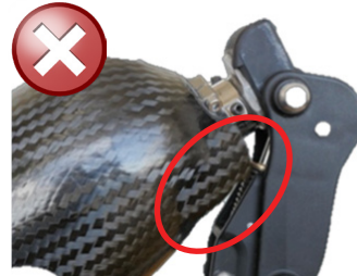
Schéma 13. Butée de flexion mal positionnée
