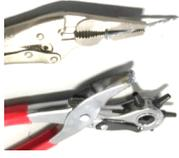
2 Utiliser un poinçon pour cuir ou tout objet pointu pour percer des trous dans le matériau de la chaussure
