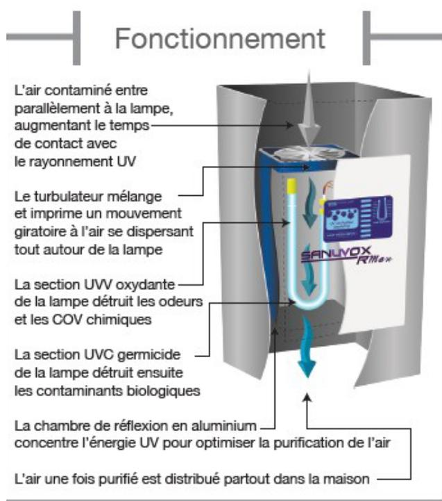
Plus le temps de contact de l'air avec le rayonnement UV est long, plus l'énergie UV peut être transmise et permettre une destruction maximale, ce qui explique **les meilleurs résultats**.
